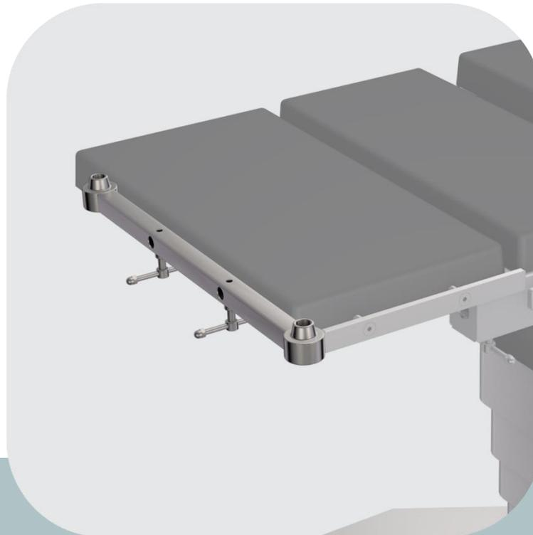
O adaptador neuro esta fabricado en acero inoxidable AISI 304, la distancia para fijar el Mayfield es de 173 mm y el diámetro del orificio es de 17 mm.
